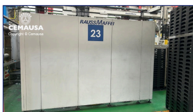
Inyectora termoplástico 1000 ton.
