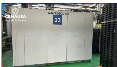
Inyectora termoplástico 1000 ton.
